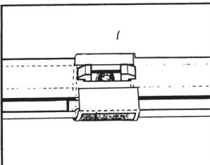
Zuerst weiße Isolierfolie, dann Metallfolie wie gezeigt über Lichtleiter und Halteklemmer kleben (vorher Schutzpapier vom Kleber entfernen). Stick, firstly the white insulating protective foil then the metall foil over the light dispenser and the holding clips, as shown (protective paper should first of all be removed from the sticky surfaces).
