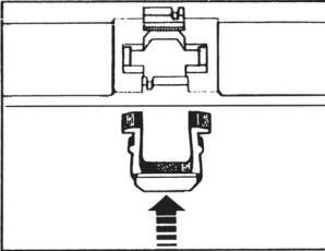
Transparente Halteklemmer von unten in die mittlere Aussparung des Lichtleiters einschnappen.
