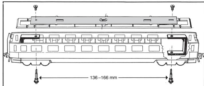
Lichtleiter mit Aussparung auf Bügel in Wagenkasten legen und festschrauben (Leiterplatte muss zum Dach zeigen).
