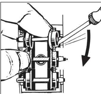
Einen Radsatz durch leichtes seitliches Aufbiegen entfernen.
