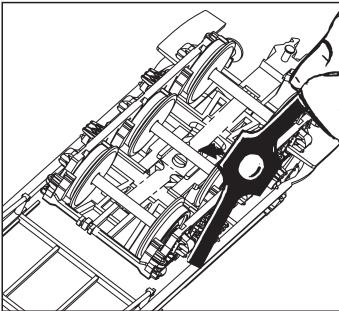
Zum Einsetzen der Stromabnehmerfeder unter die Achsen Zapfenschraube **nicht** lösen; nur über den Schraubenkopf legen. Je nach Achsstand ist die Stromabnehmerfeder (s. Fig. T10) ggf. zu kürzen (bei 4-achsigen Wagen mind. auf der Kupplungsseite). Achsen wieder einsetzen.
