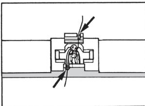
Glühlampe so in die mittlere Aussparung des Lichtleiters legen, dass die Drahtenden in den v-förmigen seitlichen Kerben liegen.
